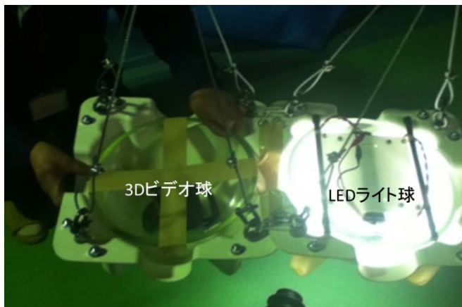
Fig. 8 ビデオカメラ球とライト球を使った撮影試験
