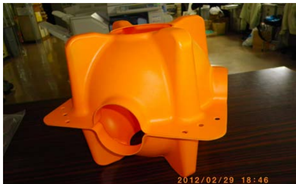
Fig. 9 真空成形により試作したハードハット
